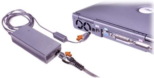
К компьютеру можно подключить [адаптер переменного тока](#) через соответствующий разъем на панели компьютера. Адаптер преобразует напряжение переменного тока в напряжение постоянного тока, которое используется для питания компьютера.
