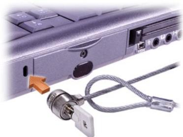
Такие устройства для портативных компьютеров обычно состоят из сегмента стального многожильного троса и замка с ключом.
