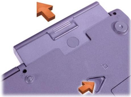
6. С усилием вставьте новую батарею в аккумуляторный отсек. Когда она полностью войдет в отсек, должен послышаться щелчок.
