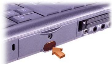
С помощью инфракрасного порта (IR) можно пересылать файлы с компьютера на другое устройство инфракрасной связи, не используя кабельные соединения. Компьютер поставляется с отключенным инфракрасным датчиком. Включить [инфракрасный датчик](#) можно с помощью программы настройки системы.
